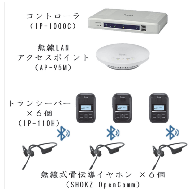
図1 骨伝導式無線インカムの構成
