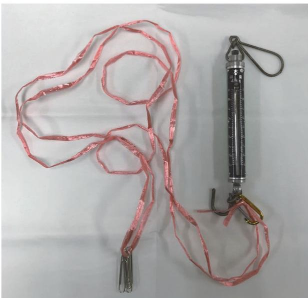
図3 ばねはかりと取り付けた金属
