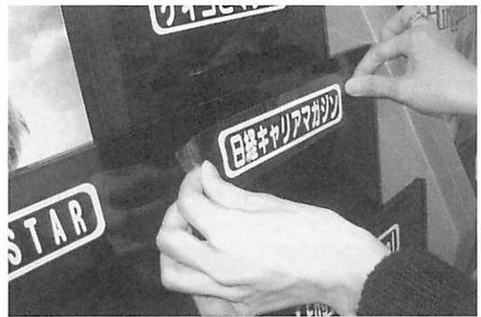
図6. カuttingシートを張る作業
